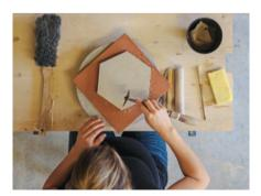
HANDARBEIT Jede Fliese erhält per Hand einen Feinschliff. Dann muss sie noch etwa zehn Tage aushärten, bis sie bei 150 Grad vorgebrannt wird
