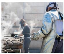
**FEURIG** Nach dem zweiten Brand bei 1.000 Grad wird die glühende Fliese mit einer Zange aus den Ofen genommen und luftdicht mit Sägemehl zugedeckt
