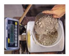
BASIS Die Kombination von unterschiedlichen Ton- und Lehmerden wird mit Quarzsand und Schamott gemischt und danach in Fliesenform gepresst
